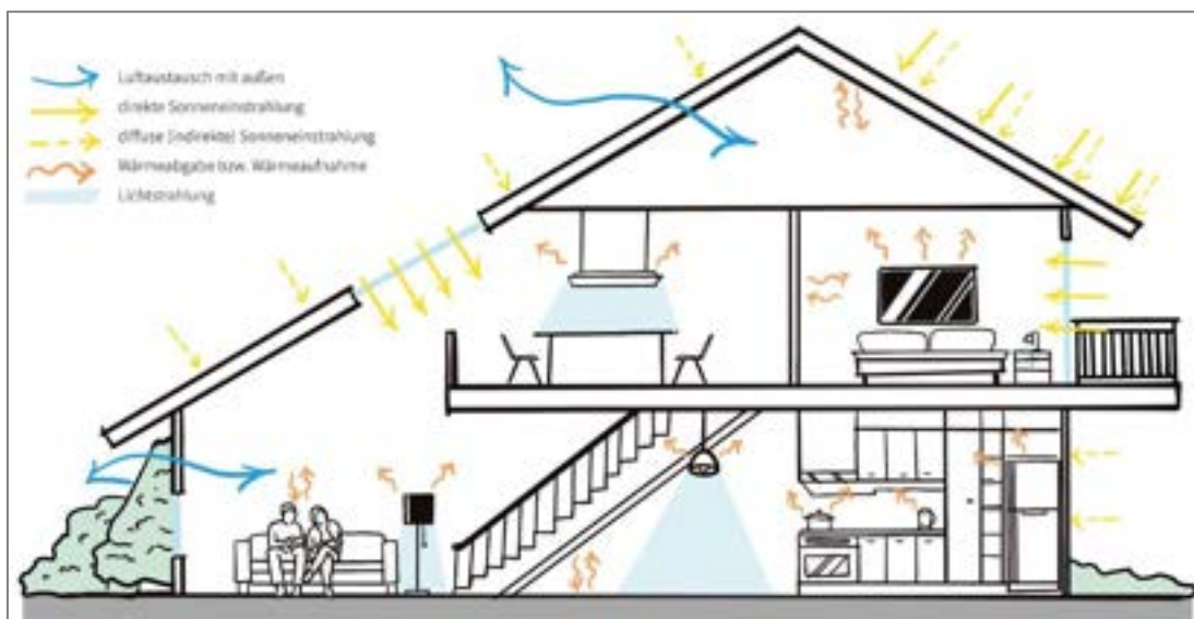
Abbildung 14: Einflussfaktoren auf den sommerlichen Wärmeschutz [3]
